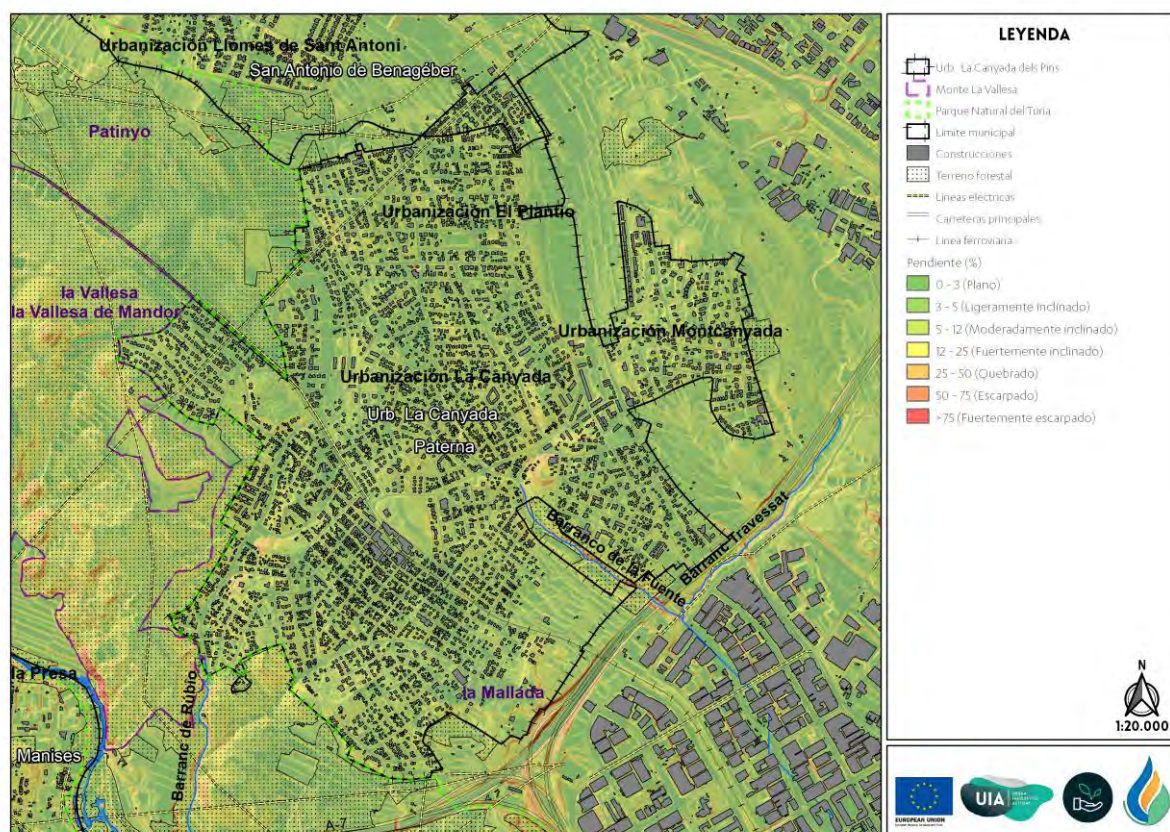
Imagen 6. Pendientes extraídas a partir del vuelo LIDAR realizado sobre la zona de estudio con paso de malla de 1. Fuente: MEDI XXI CSA.
